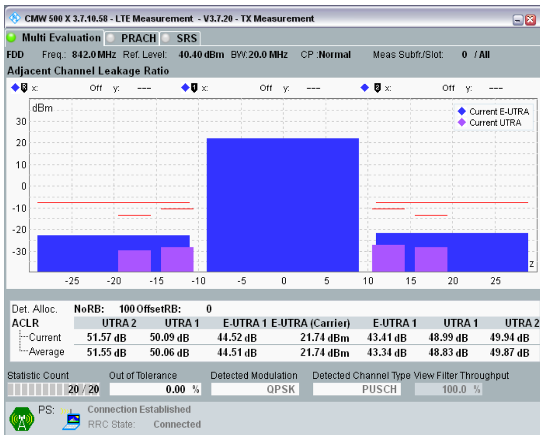
Band20 QPSK BW=20MHz Channel=24250 RB Size=18 Position=#0.png
