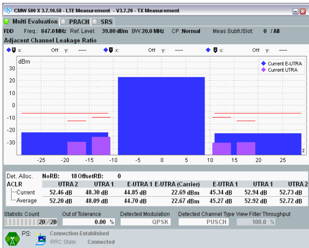
Band20 QPSK BW=20MHz Channel=24300 RB Size=18 Position=#Max.png
