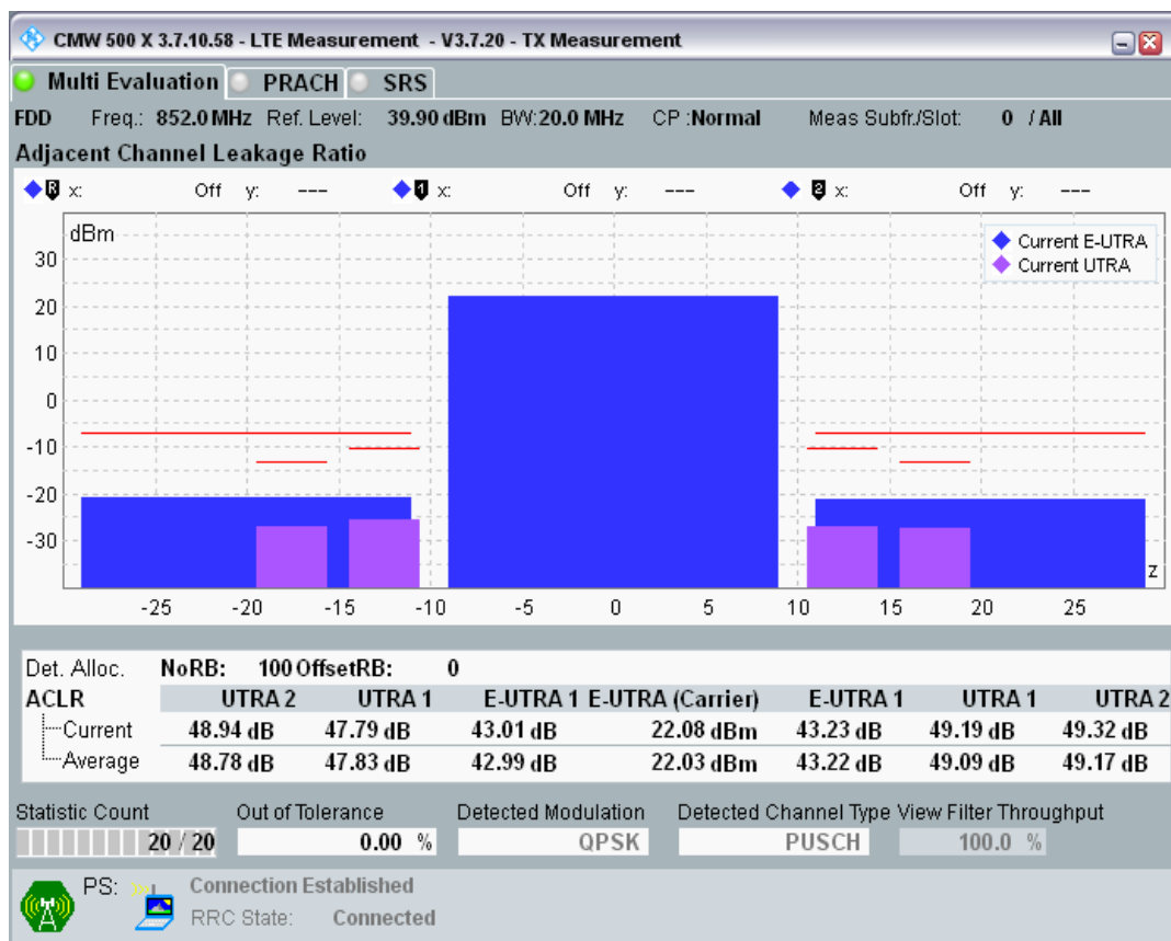
Band20 QPSK BW=20MHz Channel=24350 RB Size=18 Position=#0.png
