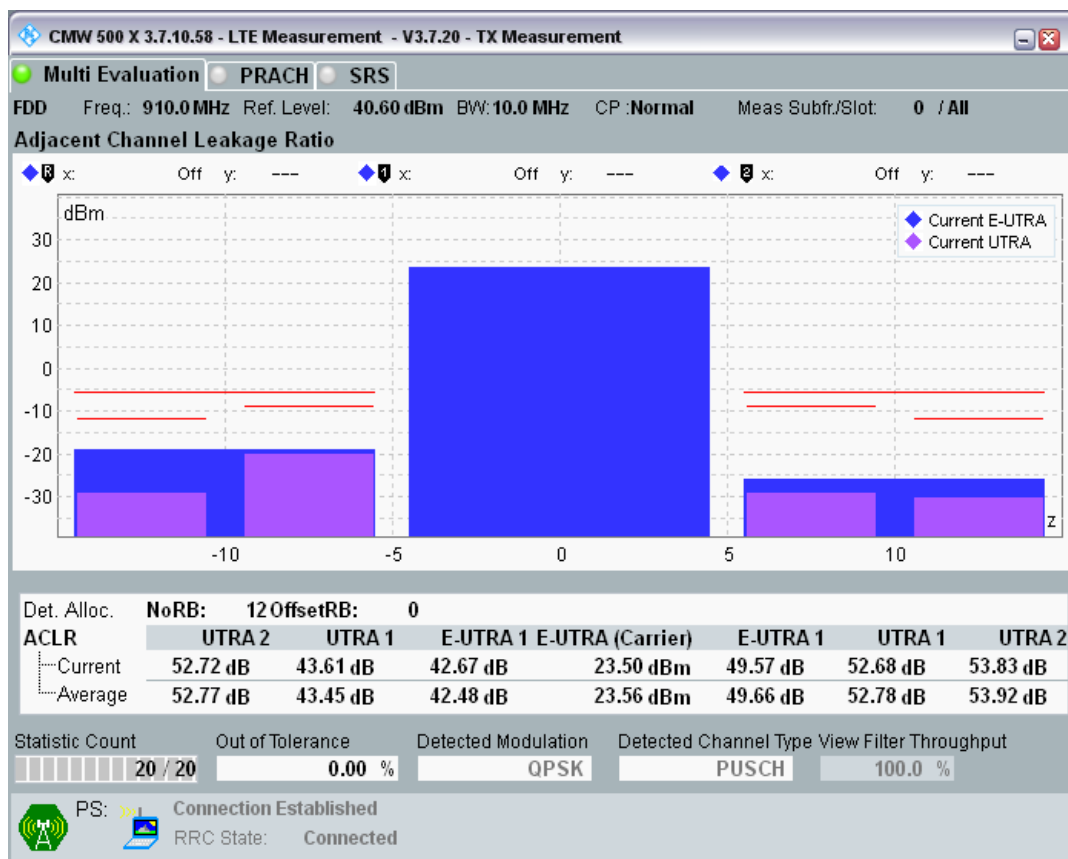
Band8 QPSK BW=10MHz Channel=21750 RB Size=12 Position=#Max.png
