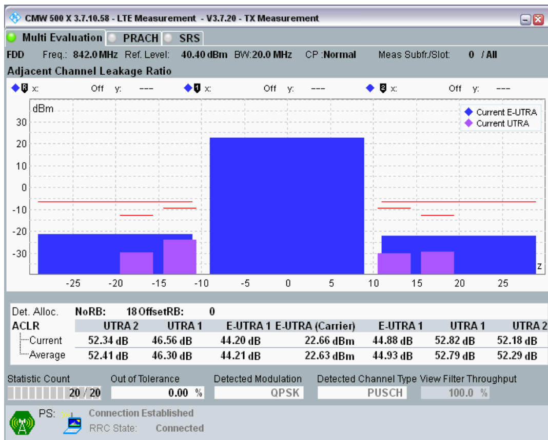
Band20 QPSK BW=20MHz Channel=24250 RB Size=18 Position=#Max.png
