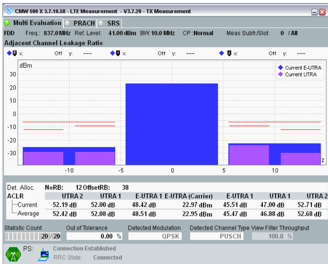
Band20 QPSK BW=10MHz Channel=24200 RB Size=50 Position=#0.png
