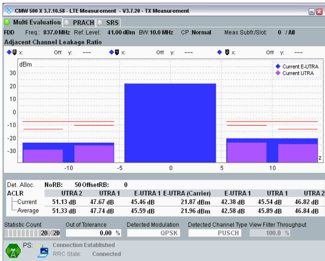
Band20 QPSK BW=10MHz Channel=24300 RB Size=12 Position=#0.png
