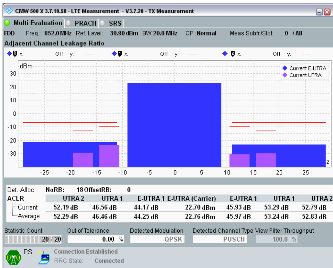
Band20 QPSK BW=20MHz Channel=24350 RB Size=18 Position=#Max.png
