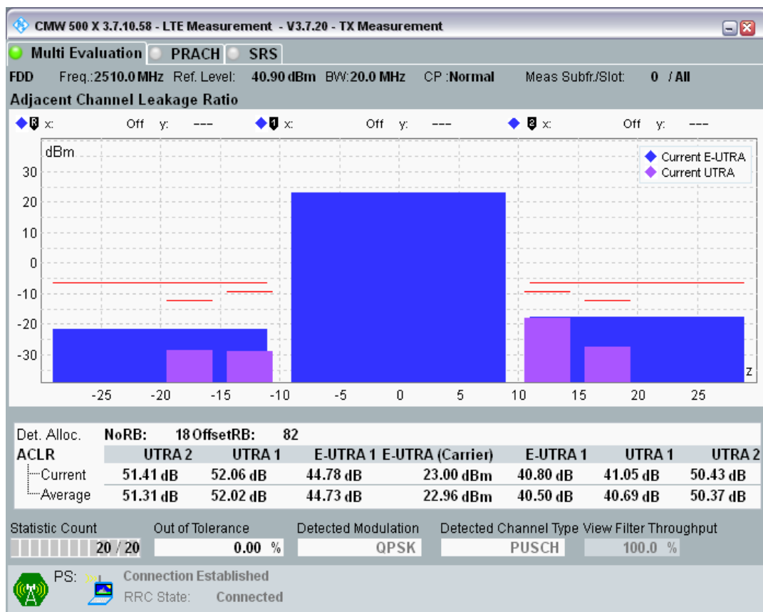
Band7 QPSK BW=20MHz Channel=21100 RB Size=100 Position=#0.png
