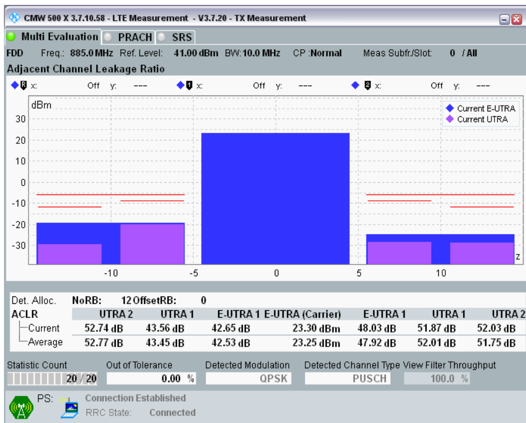
Band8 QPSK BW=10MHz Channel=21500 RB Size=12 Position=#Max.png
