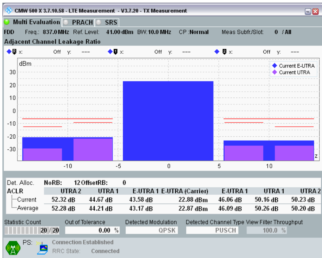
Band20 QPSK BW=10MHz Channel=24200 RB Size=12 Position=#Max.png
