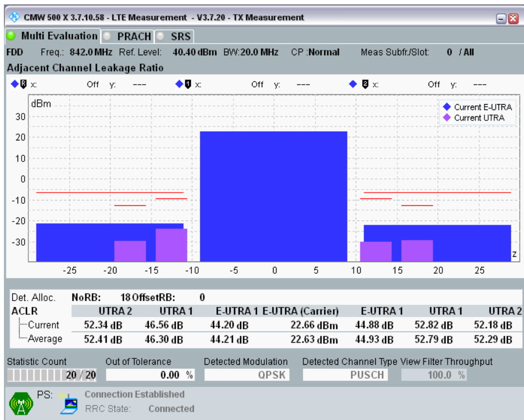
Band20 QPSK BW=20MHz Channel=24250 RB Size=18 Position=#Max.png
