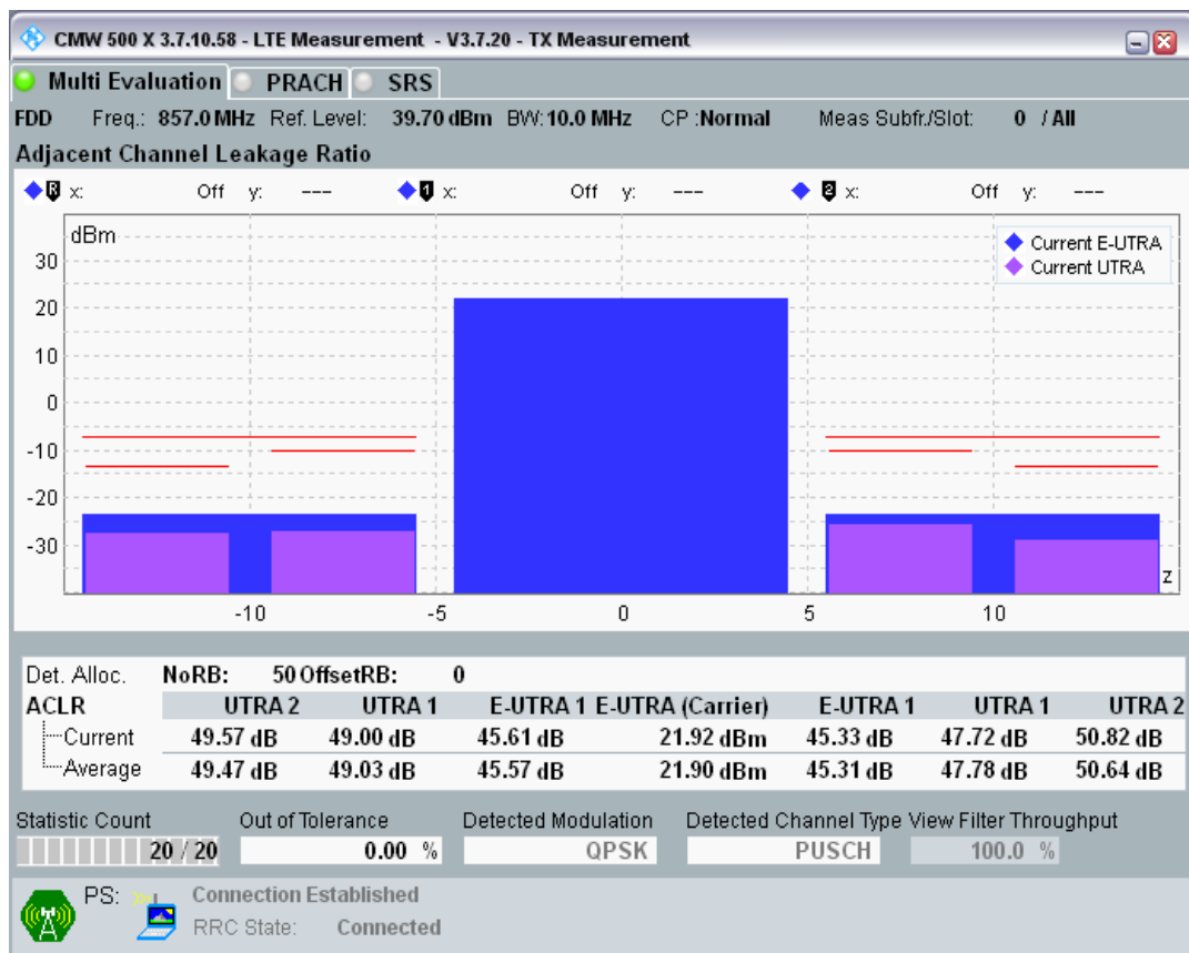
Band20 QPSK BW=20MHz Channel=24250 RB Size=100 Position=#0.png
