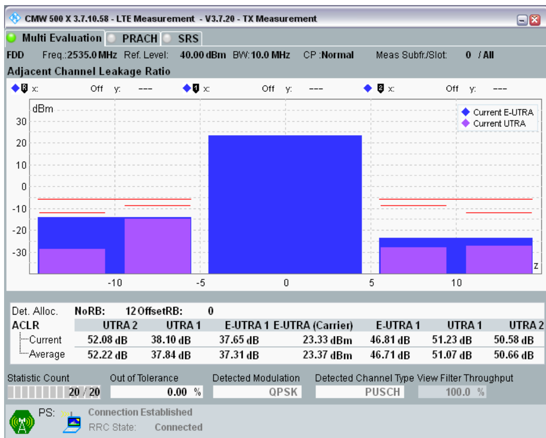
Band7 QPSK BW=10MHz Channel=21100 RB Size=12 Position=#Max.png
