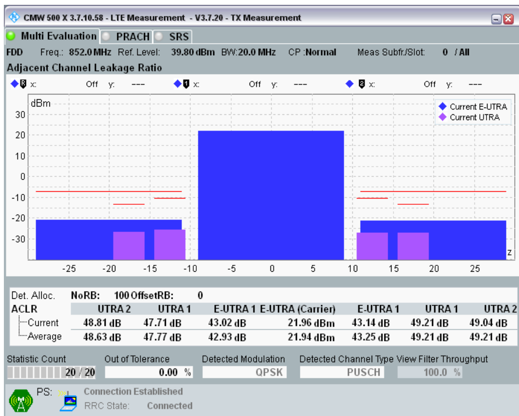
Band20 QPSK BW=20MHz Channel=24350 RB Size=18 Position=#0.png
