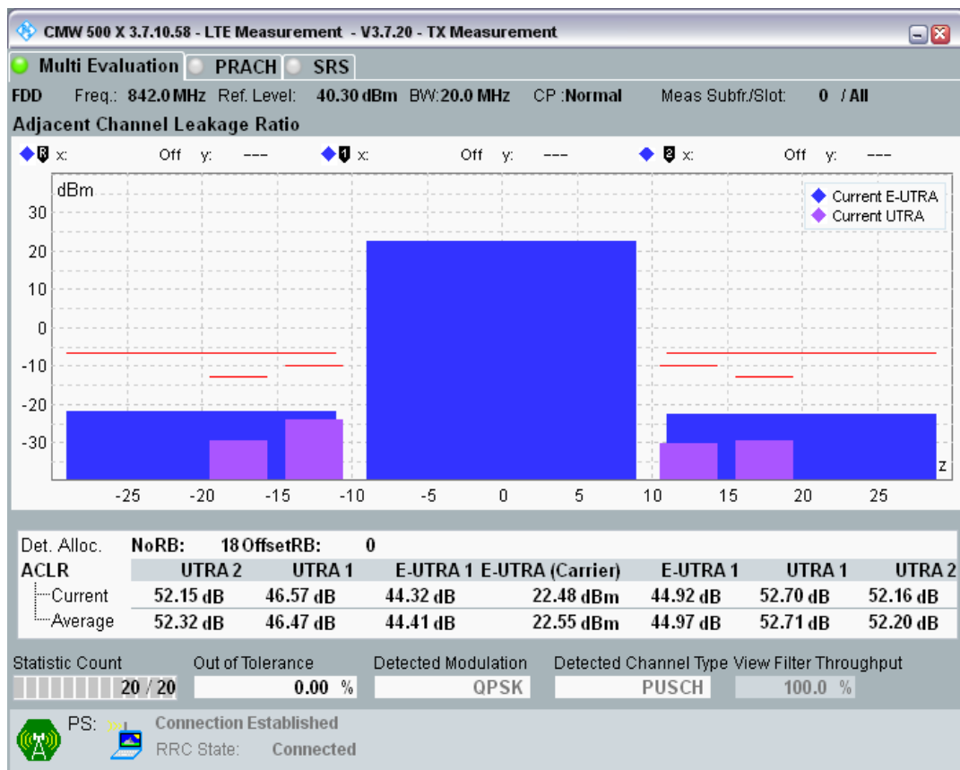
Band20 QPSK BW=20MHz Channel=24250 RB Size=18 Position=#Max.png
