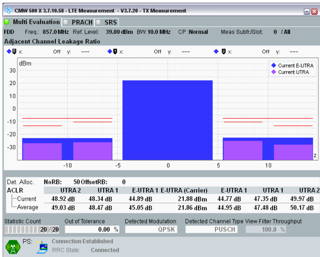
Band20 QPSK BW=20MHz Channel=24250 RB Size=100 Position=#0.png
