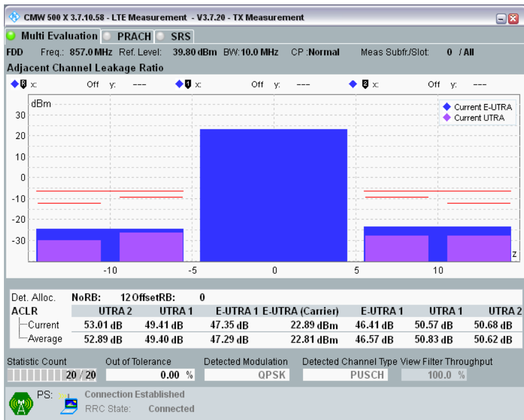
Band20 QPSK BW=10MHz Channel=24400 RB Size=12 Position=#Max.png
