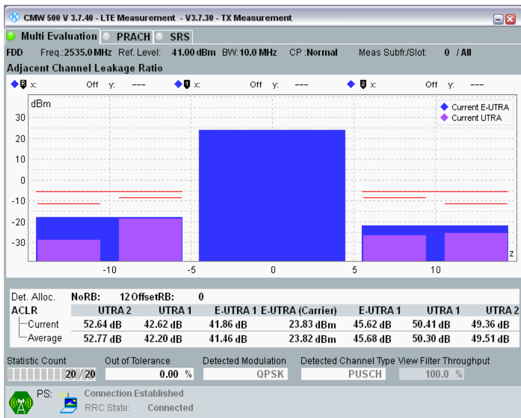
Band7 QPSK BW=10MHz Channel=21100 RB Size=12 Position=#Max.png
