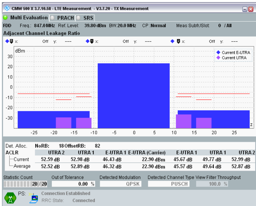
Band20 QPSK BW=20MHz Channel=24350 RB Size=100 Position=#0.png
