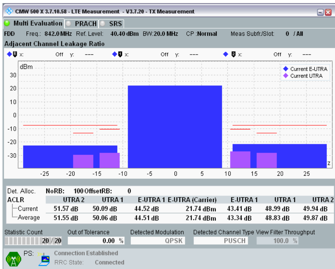
Band20 QPSK BW=20MHz Channel=24250 RB Size=18 Position=#0.png
