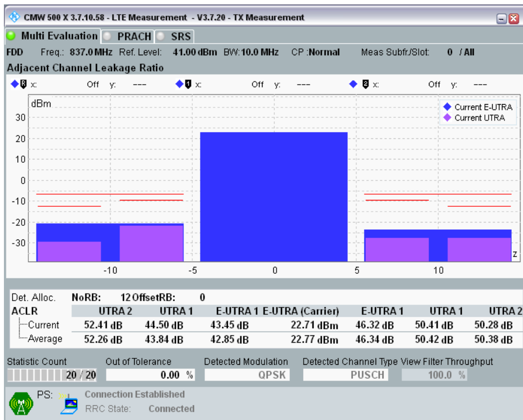
Band20 QPSK BW=10MHz Channel=24200 RB Size=12 Position=#Max.png
