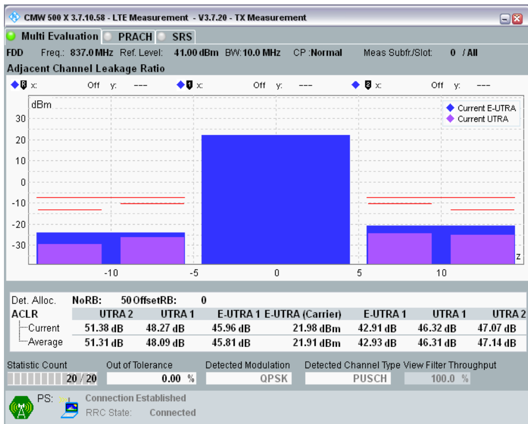
Band20 QPSK BW=10MHz Channel=24300 RB Size=12 Position=#0.png
