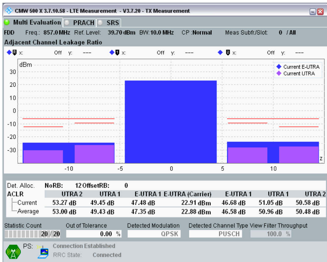
Band20 QPSK BW=10MHz Channel=24400 RB Size=12 Position=#Max.png
