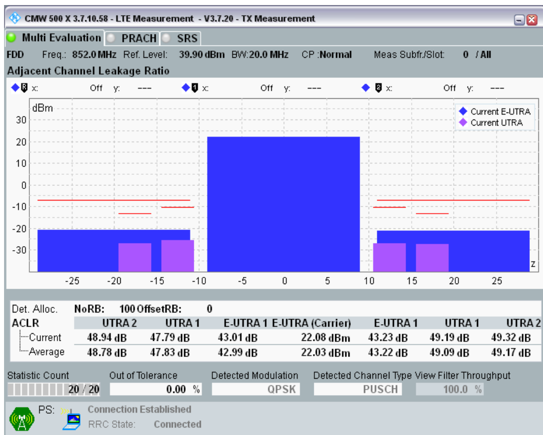
Band20 QPSK BW=20MHz Channel=24350 RB Size=18 Position=#0.png
