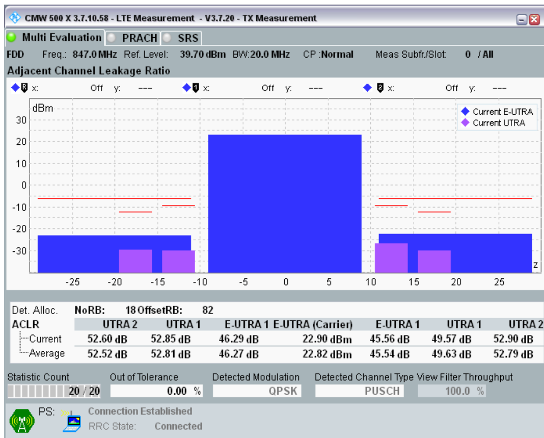
Band20 QPSK BW=20MHz Channel=24350 RB Size=100 Position=#0.png
