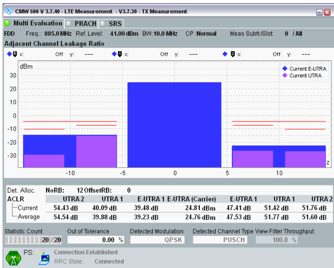
Band8 QPSK BW=10MHz Channel=21500 RB Size=12 Position=#Max.png
