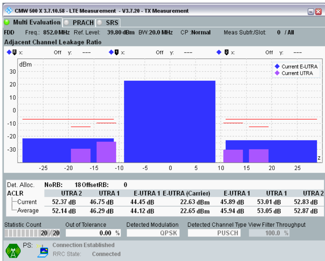
Band20 QPSK BW=20MHz Channel=24350 RB Size=18 Position=#Max.png
